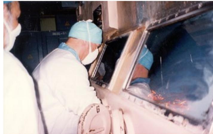
***Bild:** Konvertierung des Uranmetalls zum Oxid in einer Mayak-Werkstatt*
